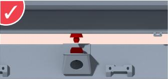
**✓** **Deichselfederung** mit einstellbarer Längsfeder (3 Positionen).
