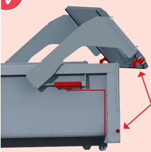
**Öffnungszylinder der Heckklappe**, die durch den Türarm und den oberen Kastenrahmen geschützt sind.
