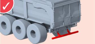
**✓** **Boggie Federung mit parabelförmigen Blattfedern** (bei den Modellen 5300D bis 6700D): Großer Radweg zur Verbesserung der Geländegängigkeit und der Lastverteilung.
