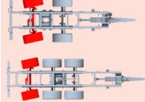
**+** **Zwangslenkachse** im Vorwärts- und Rückwärtsgang (bei Tridem, auch an der Vorderachse erhältlich).
