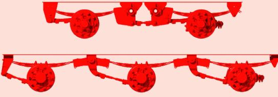
**+** **Nachlaufachse** mit hydraulischer Blockierung für Rückwärtsfahrten (bei Tridem, auch an der Vorderachse erhältlich).
