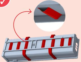
**Omega-Verstärkungen** zur Versteifung des Bodens und der Seitenwände.
