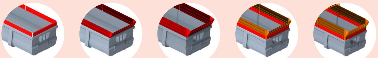
**Aufsätze von 300** (Stahl oder Aluminium), **500** (Aluminium) oder **700 mm** (Aluminium) sind kombinierbar bis zu einer Gesamthöhe von 1 m. Um das Gewicht einzugrenzen und die Montage durch eine Person zu erleichtern, gibt es zweiteilige Seitenaufsätze bei ein- und zweiachsigen Modellen und dreiteilige bei dreiachsigen Modellen.
