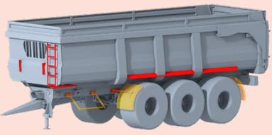
**✓** **Robuster Rohrrahmen mit Längsträger 300 x 100 x 10 mm** auf das gesamte Sortiment, außer auf den Modellen 4700S, 5300S und 5300D (300 x 100 x 8 mm).
